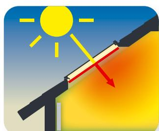
La radiación que pasa a través del cristal incide sobre la cortina, elevando la temperatura interior.
